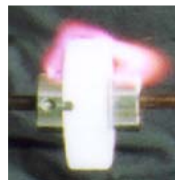
沿面放電試験
