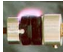
沿面放電試験
