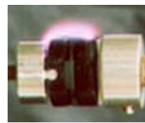
沿面放電試験
