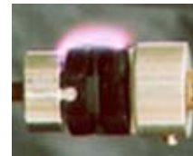
沿面放電試験
