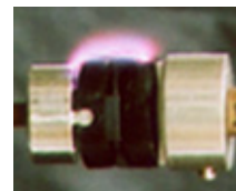
沿面放電試験
