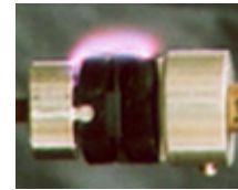
沿面放電試験
