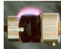
沿面放電試験
